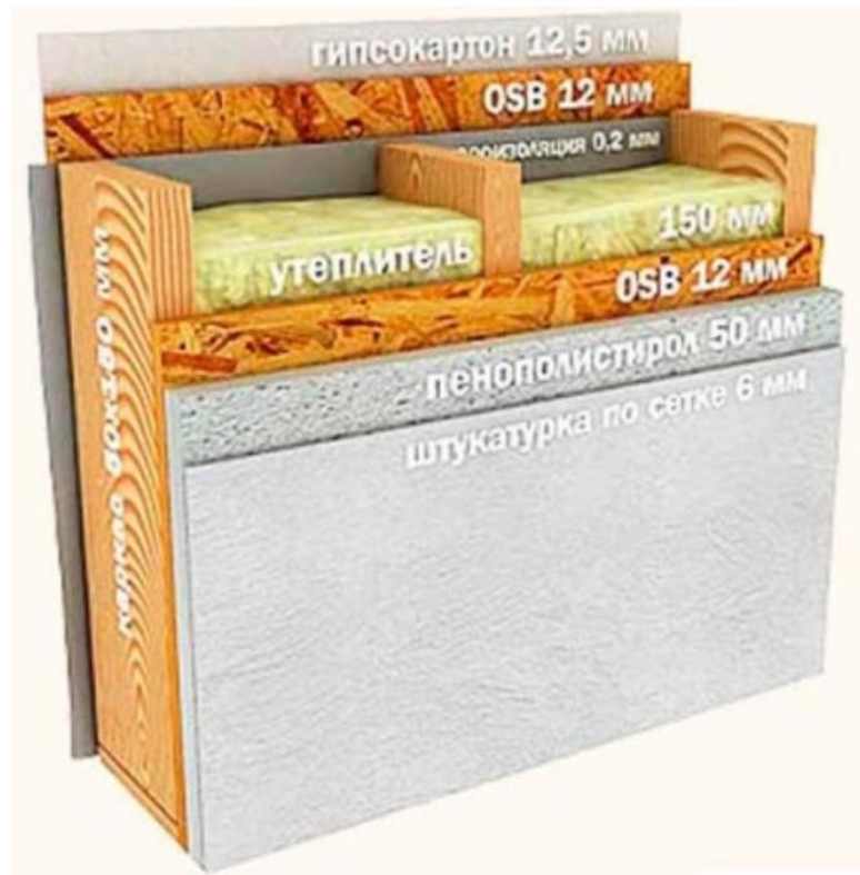
Рис.2.3 Товщина каркасних стін: специфіка і склад [ https://yak.koshachek.com/articles/tovshhina-stin-karkasnogo-budinku-poradi-ta.html#google_vignette ]
