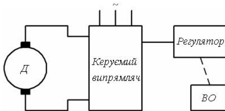
Рис.4.6 Схема регулювання двигуна постійного струму з незалежним збудженням який живиться від керуемого випрямляча.
