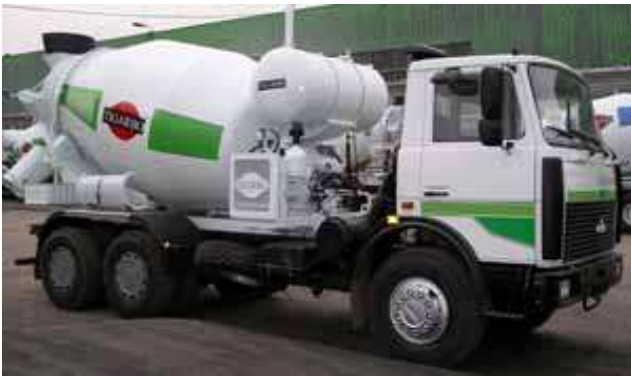
Рис. 14. Привод змішувального барабана від автономного двигуна.
