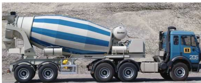
Рис. 4. Автобетонозмішувач із об'ємом 12 \text{ м}^3 на напівпричепі.
