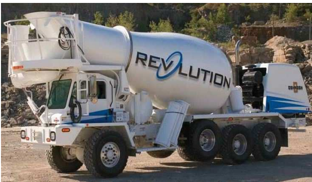
Рис.6. Автобетонозмішувач з фронтальним вивантаженням фірм Oshkosh і Terex.
