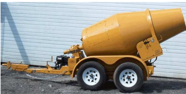
Рис. 7. Причпний змішувач із об'ємом 3 м 3 .
