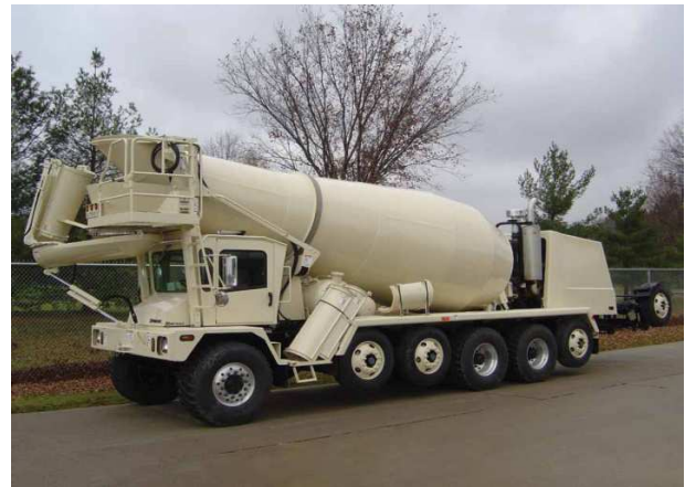
Рис.6. Автобетонозмішувач з фронтальним вивантаженням фірм Oshkosh і Terex.
