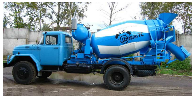
Рис. 8. Автобетонозмішувач фірми "Дизель ДС" об'ємом 2 м 3 .
