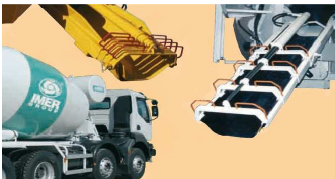
Рис. 12. Автобетонозмішувач з телескопічним лотком фірми IMERGROUP.
