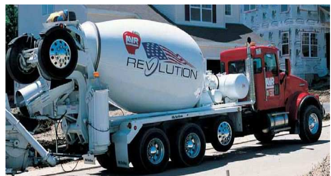
Рис. 13. Автобетонозмішувач з додатковим візком фірми Oshkosh.
