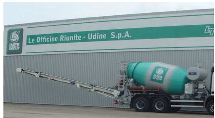
Рис. 11. Автобетонозмішувач з конвеєром фірми IMERGROUP.
