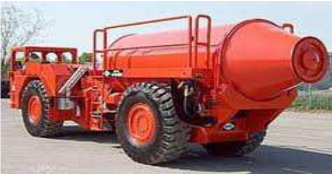
Рис. 9. Змішувач з горизонтальним барабаном фірми Normet.
