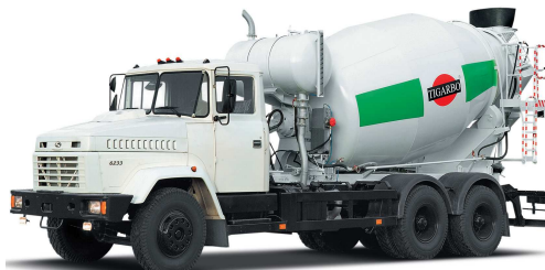
Рис. 2. Автобетонозмішувач із об'ємом 7 \text{ м}^3 .
