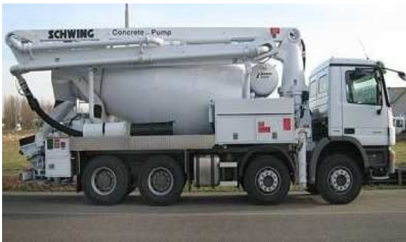
Рис. 10. Автобетонозмішувач з бетононасосом фірми Stetter.
