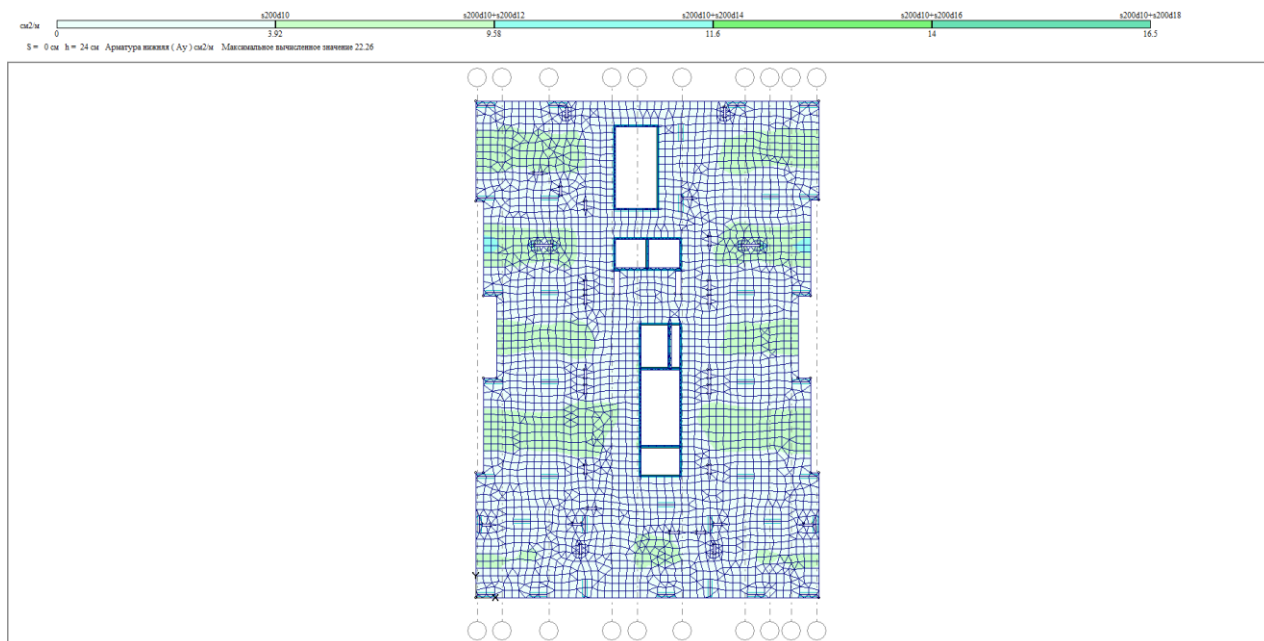
Рис. 2.10 Ізополя нижнього армування по осі Y
