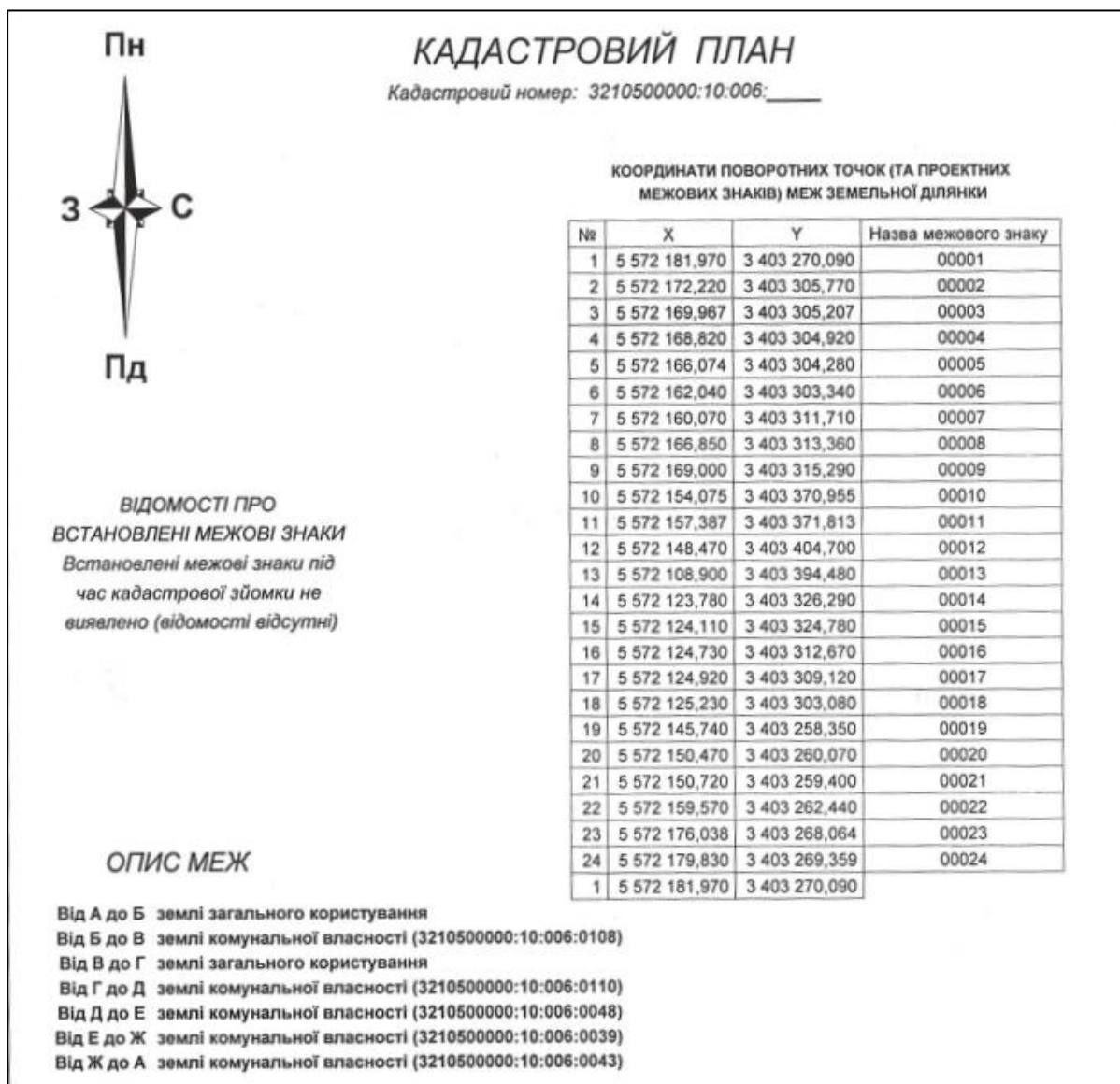
Рис. 3.5 Продовження кадастрового плану земельної ділянки із зазначеними відомостями про координати поворотних точок (та проектних межових знаків) меж земельної ділянки
