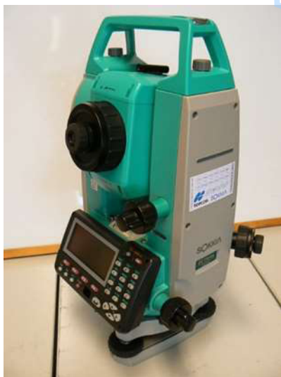
Рис. 1.8. Зовнішній вигляд тахеометра Sokkia Set 610
