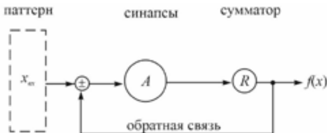
Рис. 8.6 — Упрощенная модель нейронных сетей с обратными связями (прототип рекуррентной сети RNN )
