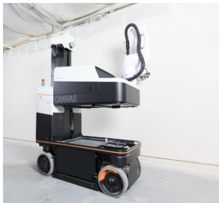
Рисунок 4. Робот-штукатур Canvas Robotics
