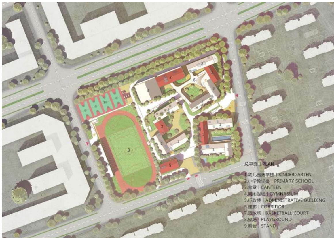
Рис.1.3.9. Генеральний план. Ханчжоу Хайшу школа майбутнього Sci-Tech City, Арх. LYCS Architecture , Китай
