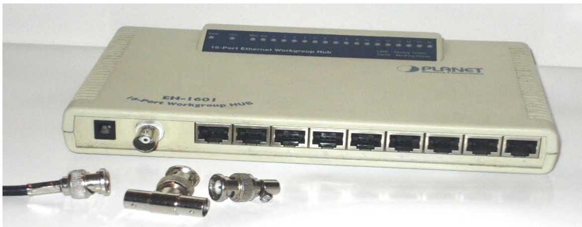
Рис. 1.5. Концентратор ( HUB ) з комплектом засобів для з'єднання з коаксіальним кабелем (на передньому плані зліва направо розміщені: кінець кабелю з роз'єднувачем, T- з'єднувач і термінатор)
