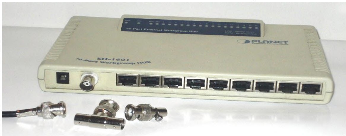
Рис. 2.3. Концентратор (HUB) з BNC-роз'єднувачем (на передньому плані зліва направо розміщені: кінець тонкого коаксіального кабелю зі роз'єднувачем, Т-з'єднувач і термінатор)
