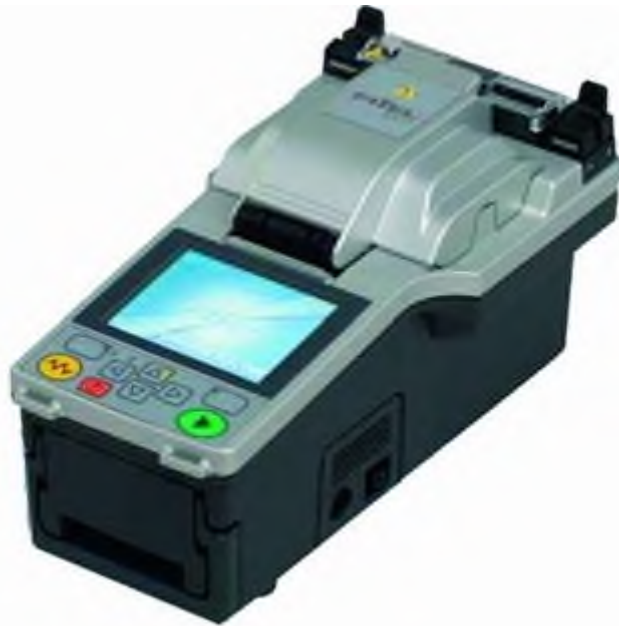
Рис. 2.8. Апарат для зварювання волокон оптичного кабелю
