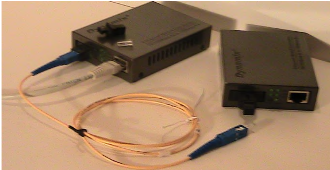
Рис. 2.12. Пара медіа конверторів, які забезпечують повний дуплекс по одномодовому волокну довжиною до 20 км зі швидкістю 100 Мбіт/с (на лівому медіа конверторі бачимо захисні ковпачки від гнізда і шнура)
