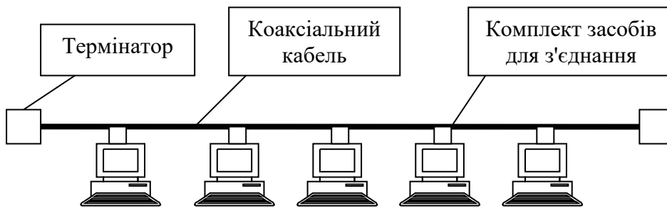
Рис. 1.4. Схема мережі Ethernet на коаксіальному кабелі
