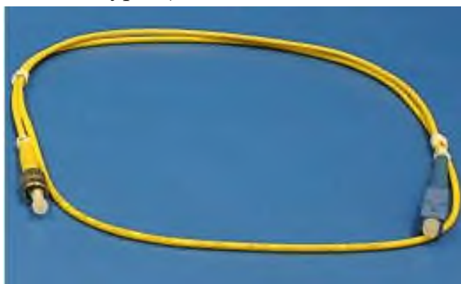
Рис. 2.10. Оптичний з'єднувальний шнур зі роз'єднувачами двох різних типів: ST (ліворуч) та SC (праворуч)
