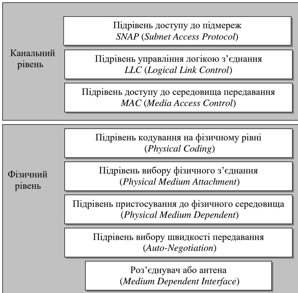
Рис. 1.9. Підрівні канального та фізичного рівнів
