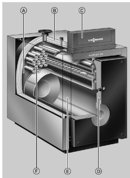
Рис. 4.1.2. Котел VITOPLEX 100 типу PV1 у розрізі.
