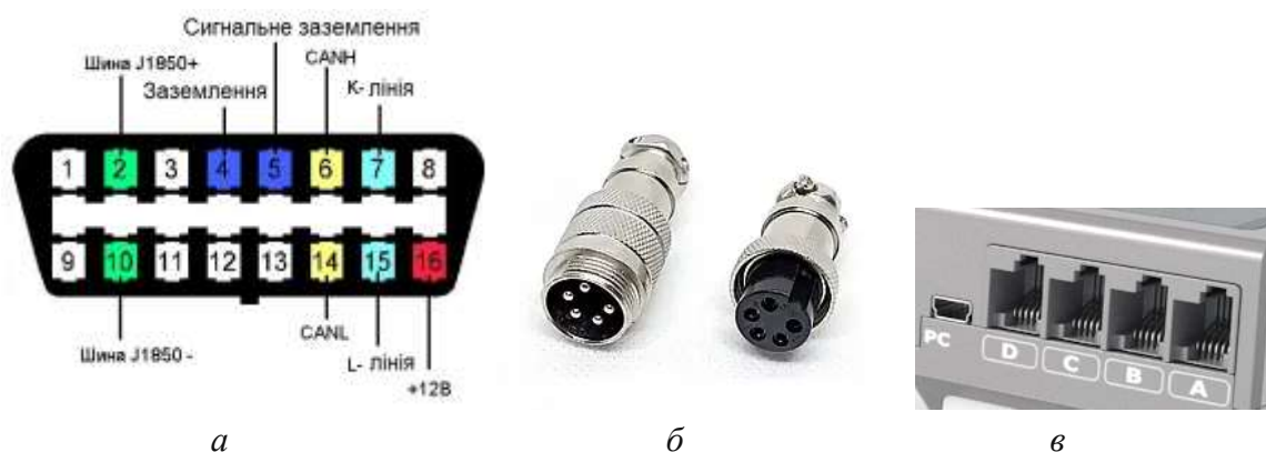
Рис. 8.1. Різновиди рознімачів: а – автомобільний OBD2; б – mini XLR M12 5; в – RJ-11 EV3
