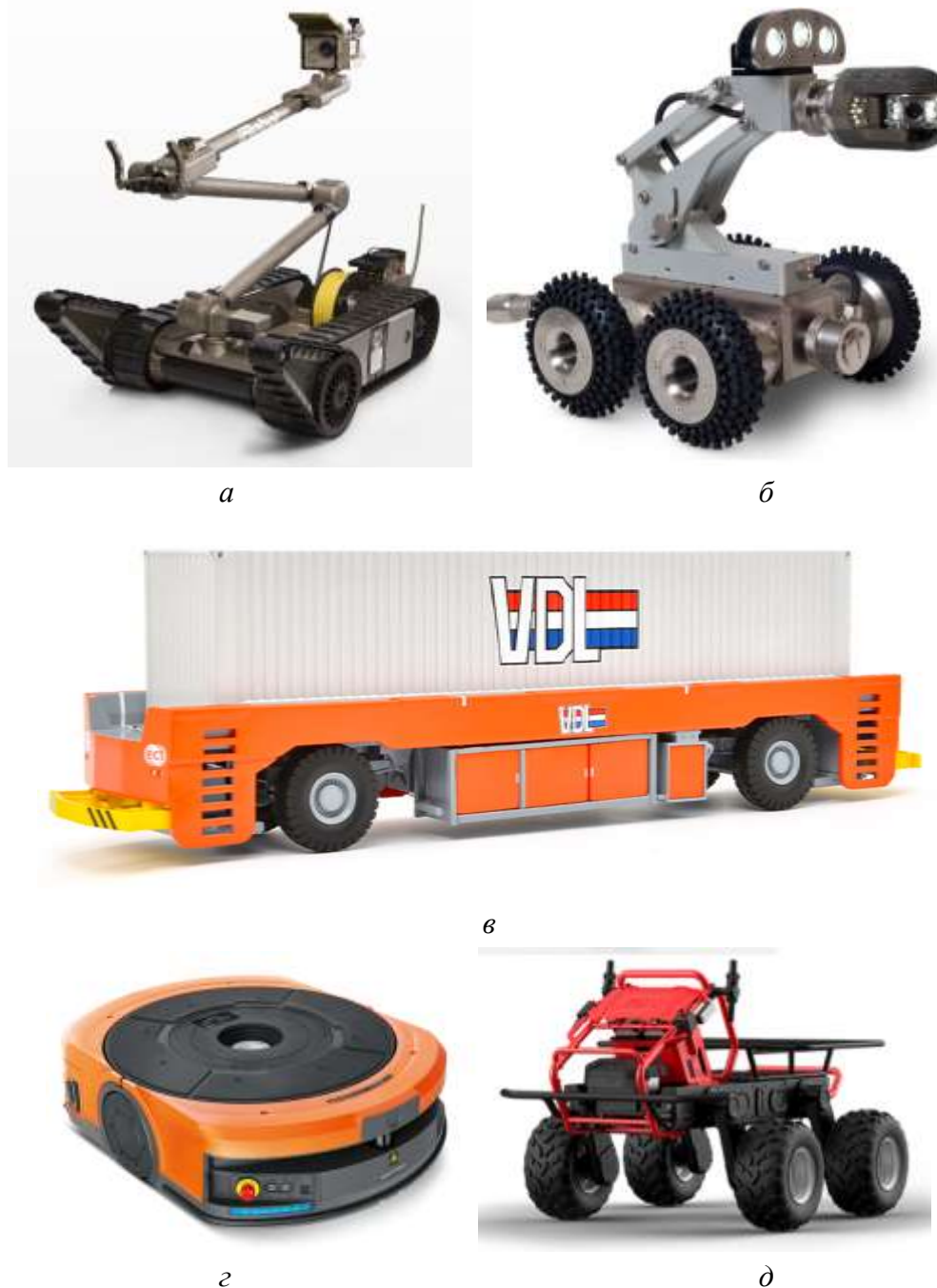
Рис. 3.1 – Транспортні роботи: а – система iRobot Packbot 510, яка застосовувалася на атомній станції Фукусима; б – траулер для обстеження трубопроводів; в – AGV (Automated Guided Vehicle), який застосовують в порту Роттердам для перевезення контейнерів; г – платформа QUICKTRON, застосовувана для автоматизації складу Amazon; д – дрон XAG R150 для сільського господарства
