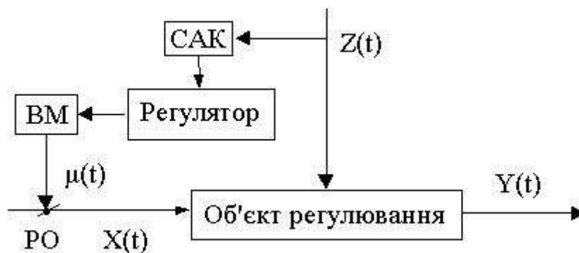
Рис. 9.3. Функціональна схем керування за збуренням: РО – регульовальний орган; САК – система автоматичного контролю вихідного параметра; ВМ – виконавчий механізм; \mu(t) – керівний вплив; Z(t) – збурювальний вплив; X(t) – вхідний параметр; Y(t) – значення вихідного параметра
