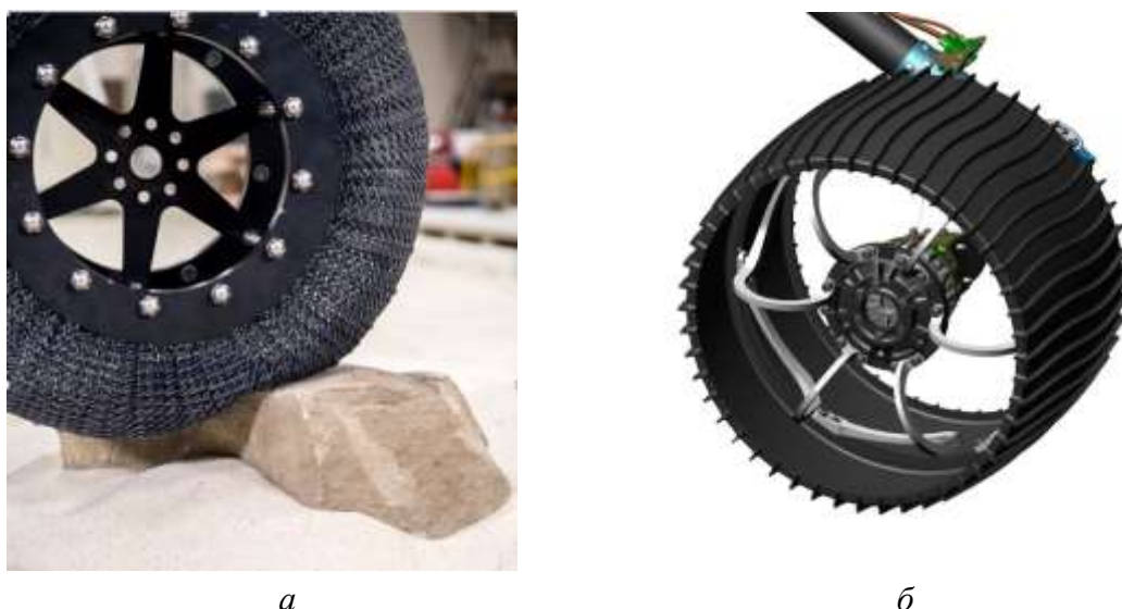
Рис. 1.13. Вигляд пружинних профілювальних коліс: а – ланцюгове; б – листове
