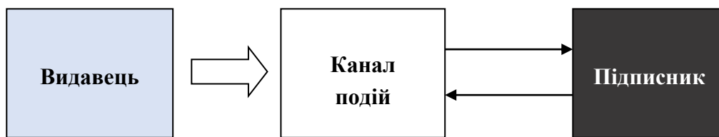
Рис. 8.14. Схема принципу Publisher-Subscriber
