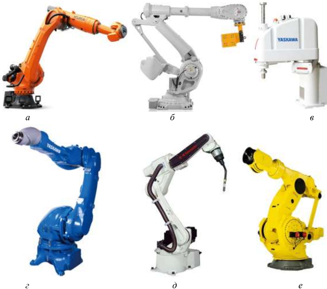
Рис. 1.1. Промислові роботи: a – універсальний маніпулятор KR Quantec 210 R2700 (KUKA); б – пакувальний маніпулятор IRB8700 (ABB); в – високоточний складальний SCARA маніпулятор MYS450F (YASKAWA); г – зварювальний робот BA006N (KAWASAKI); д – фарбувальний маніпулятор MPX2600 (YASKAWA); е – вантажний маніпулятор M-2000iA/2300 (FANUC)
