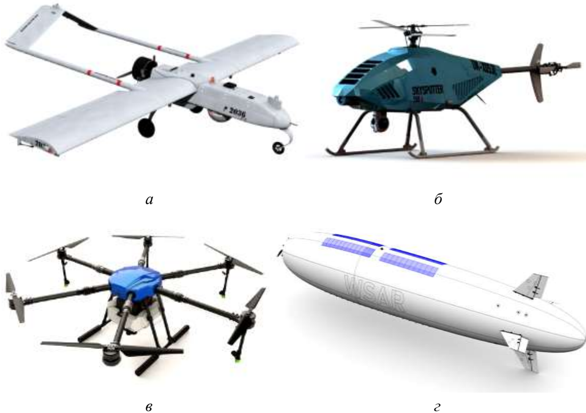
Рис. 1.10. Різновиди безпілотних літальних апаратів за видом аеродинамічної схеми: а – одномоторний планер високоплан RQ-7 Shadow (США); б – гелікоптер Kawasaki K-RACER IV (Японія); в – мультироторний MC-16 Optimal (Україна); г – аеростат Teregöz (Турція)
