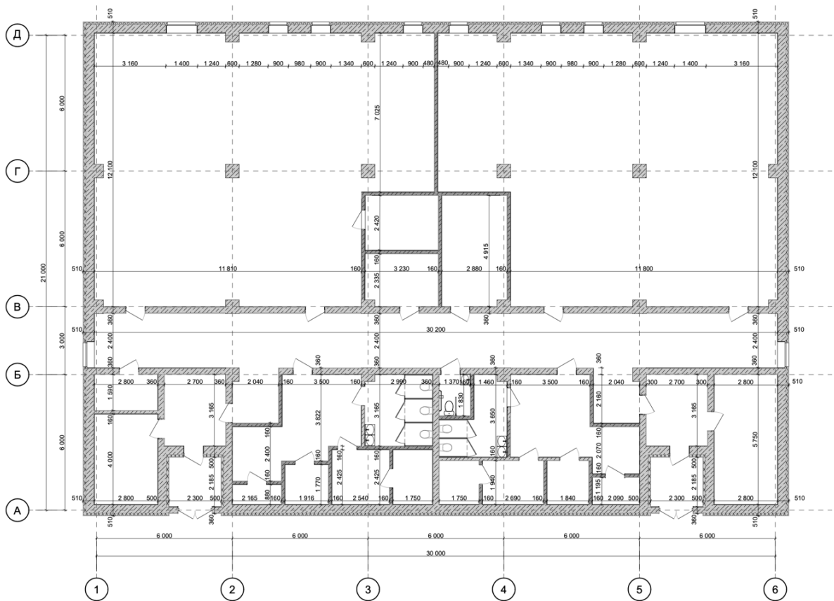
Рис. 37 Обмірний план будівлі
