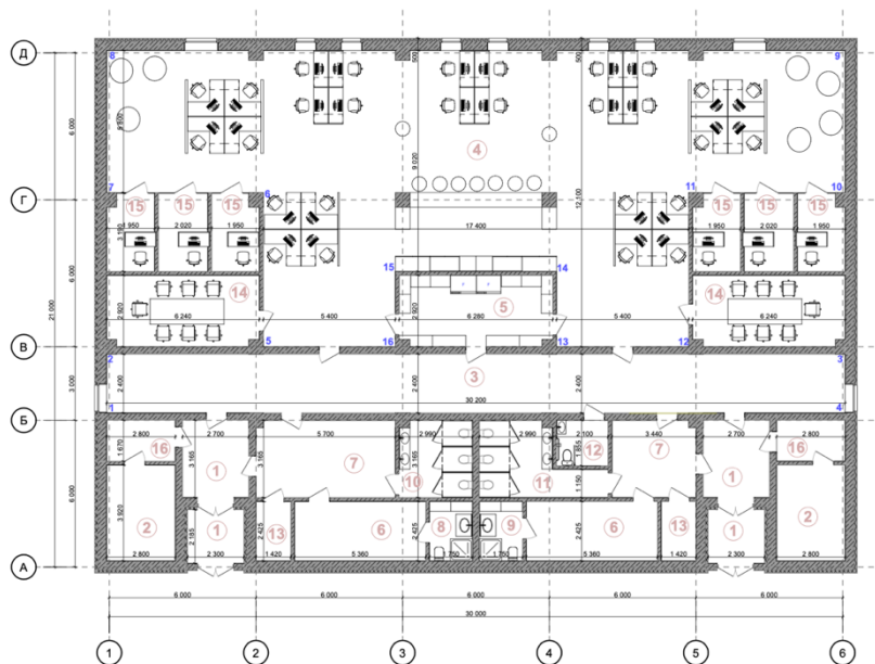
Рис. 40. План меблювання та експлікація приміщень відповідно до зон використання
