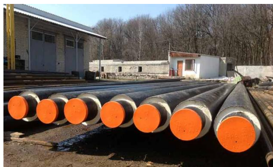
Рис.31. Готові труби в тепловій ізоляції
