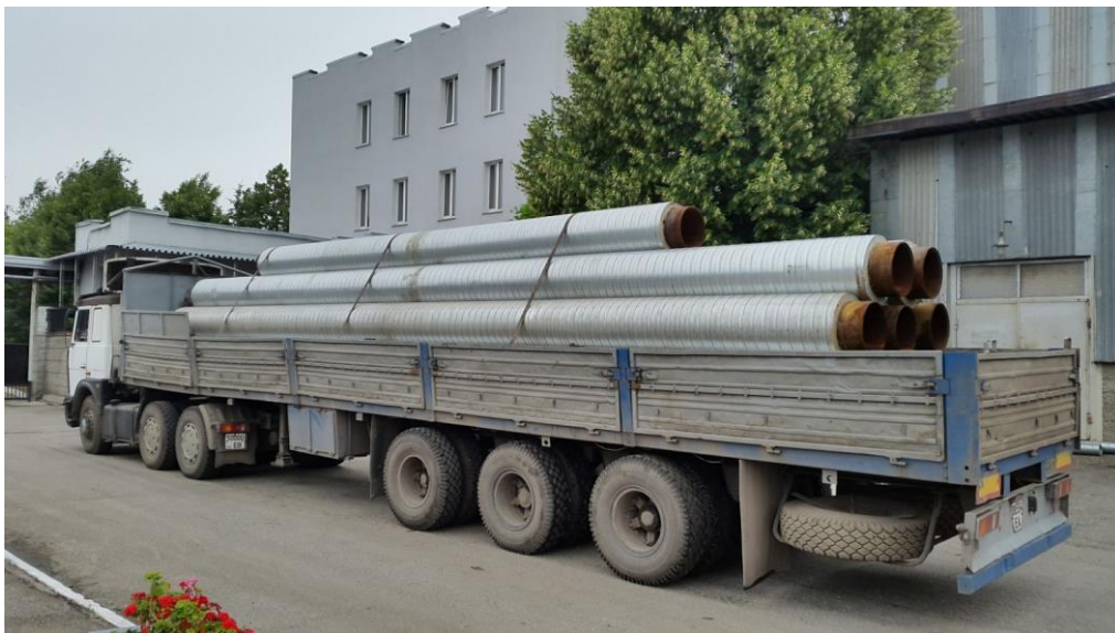
Рис.25. Транспортування готових трубопроводів на об'єкт.
