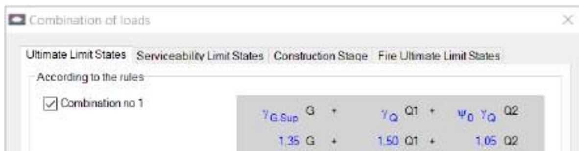
Рис. 3.10 Комбінація навантажень для перевірки міцності, стійкості та жорсткості балки з перфорованою стінкою
