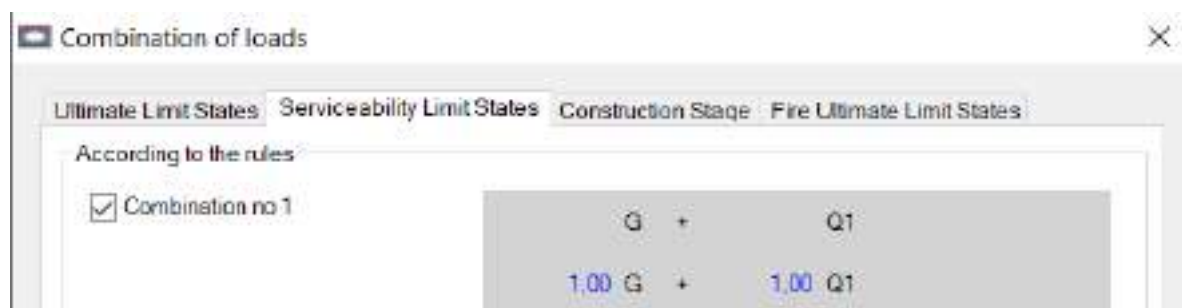
Рис. 3.11 Комбінація навантажень для перевірки прогинів та переміщень
