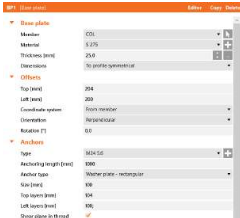
Рис. 3.43 Характеристика опорної пластини та анкерування бази колони в ПК Idea Statica
