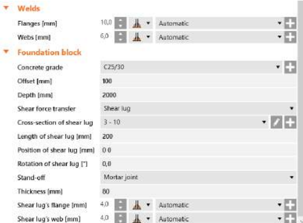
Рис. 3.44 Характеристика зварних швів та фундаментного блоку в ПК Idea Statica
