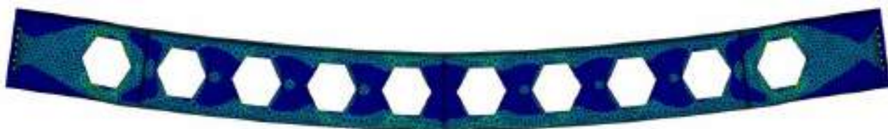
Рис. 3.28 3D інформаційна модель балки з перфорованою стінкою за нормами ДБН
