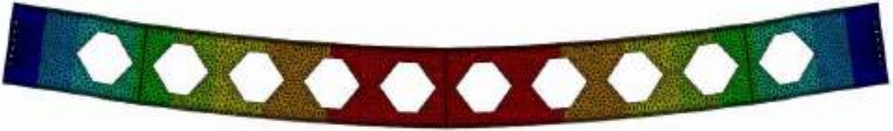
Рис. 3.26 Прогин балки з перфорованою стінкою за нормами Єврокод
