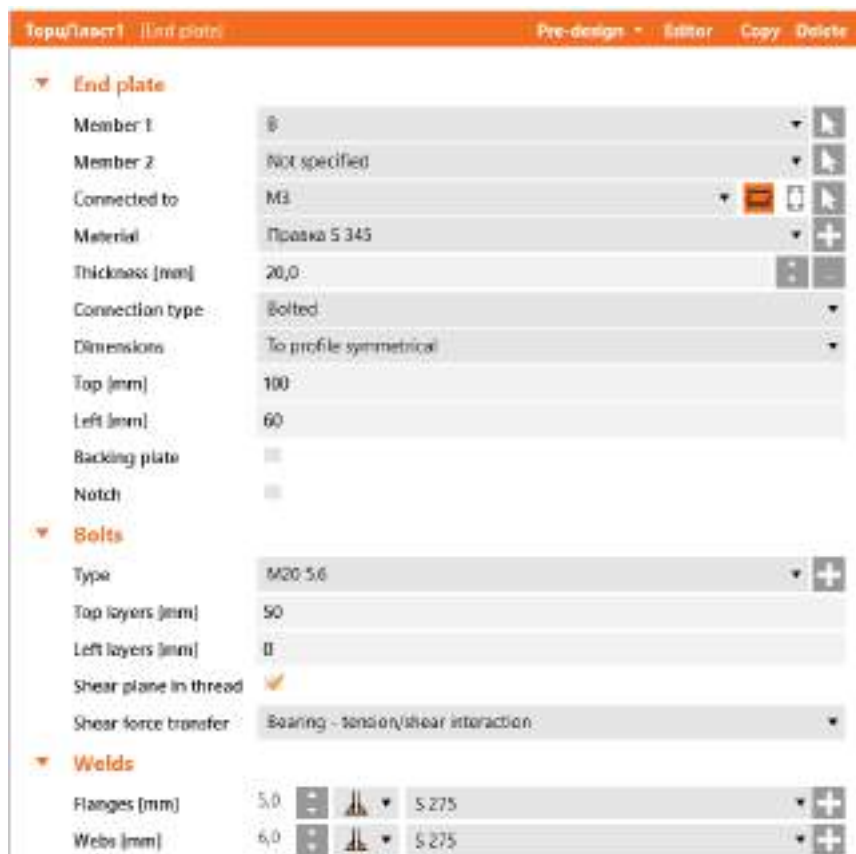
Рис. 3.33 Характеристика торцевої пластини з'єднання ГБ і К в ПК Idea Statica
