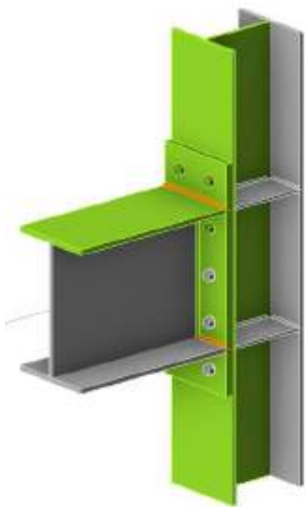
Рис.3.50 Результати розрахунку та перевірки вузла з'єднання ГБ та К-1 в ПК Idea Statica
