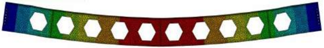
Рис. 3.30 Прогин балки з перфорованою стінкою за нормами ДБН
