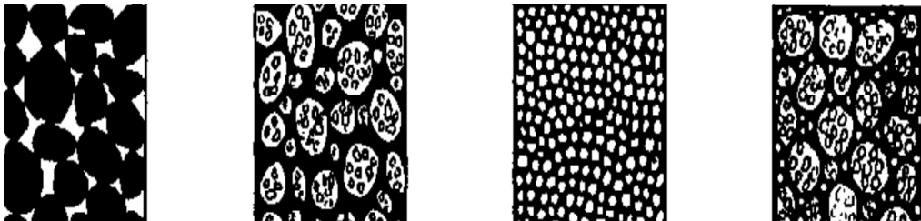
Рис. 1.5. Структура легких бетонів: а – крупнопористого на щільних заповнювачах; б – щільного на пористих заповнювачах; в – ніздрюватого; г – поризованого
