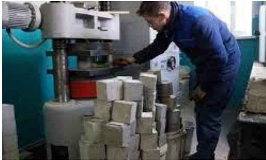
Рис.1.14. Процес випробування бетонних зразків руйнівним методом
