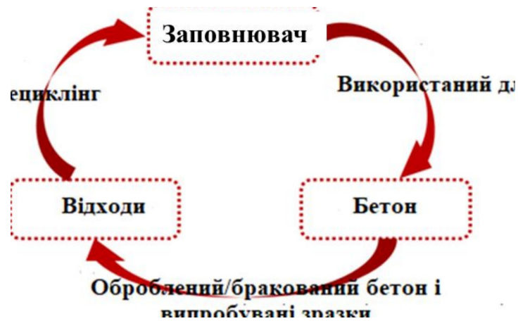
Рис.1.18. Схема процесу перероблення та застосування заповнювачів рециклінгу бетону
