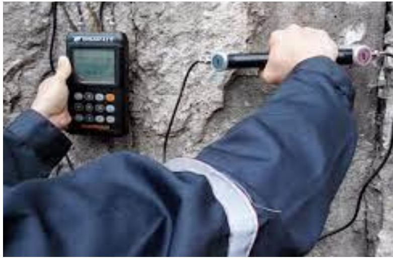
Рис.1.15. Ультразвукове обстеження спеціальним приладом
