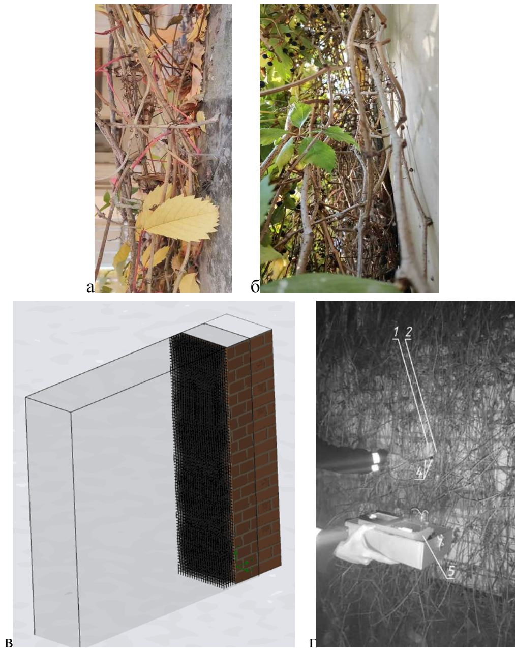
Рис. 1.5 Дослідження опору теплопередачі рослинного шару Parthenocissus quinquefolia без листя: а, б – світлини рослинного шару для побудови тривимірної моделі; в – тривимірна модель для математичного моделювання за k-ε моделлю турбулентності; г – експериментальні дослідження у КНУБА: 1 – поверхня стіни; 2 – рослинний шар; 3 – термометр температури повітря під рослинним шаром; 4 – датчик теплового потоку; 5 – вимірювач теплового потоку; термометр температури навколишнього повітря розміщено позаду
