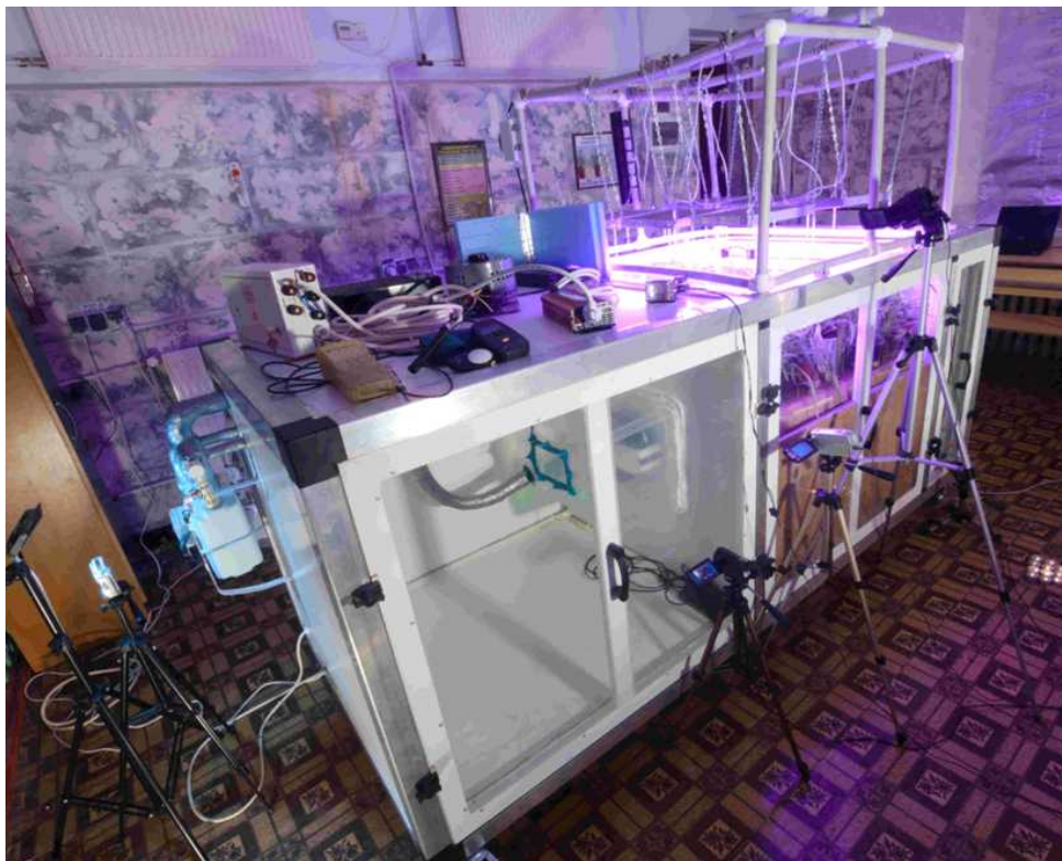
Рис. 1.8. Дослідження газообміну в рослинах в газообмінній камері КНУБА
