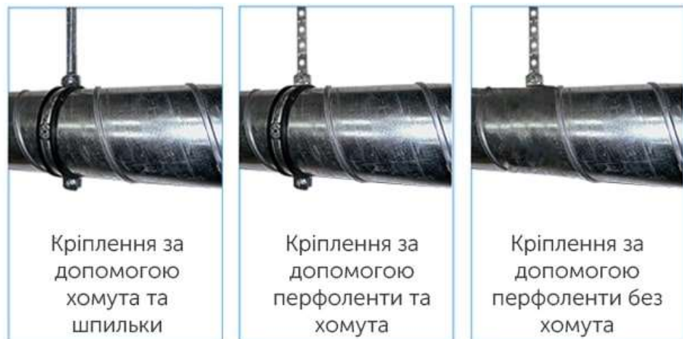
Рис. 4.2. Варіанти кріплення круглих повітропроводів
