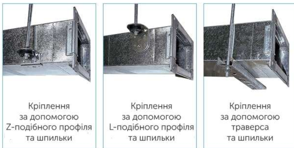
Рис. 4.3. Кріплення прямокутних повітропроводів
