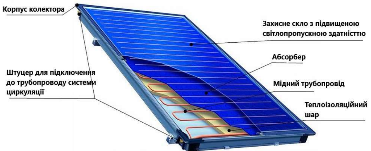
Рис. 1.4. Будова сонячного колектора
