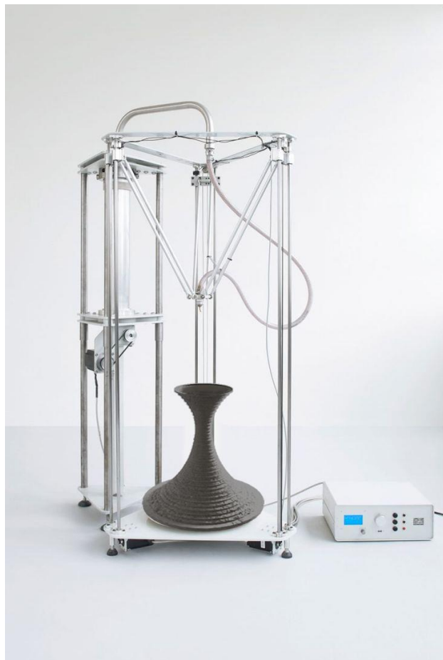
Рис. 3.4. Процес 3-д друку столику
