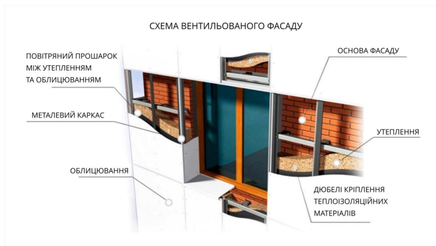
Рис. 7.1 Схема вентилязованого фасаду
