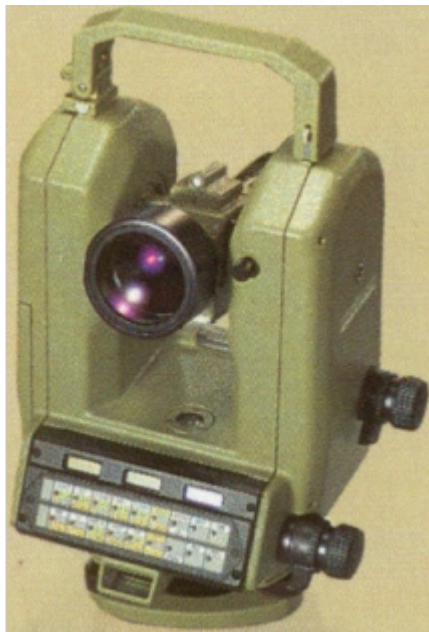
Рис. 4.9. Високоточний електронний теодоліт T2000S: 1 – дисплейна панель керування; 2 – табло результатів вимірювань; 3 – зорова труба; 4 – навідний та закріпний гвинти аліади горизонтального круга; 5 – підставка
