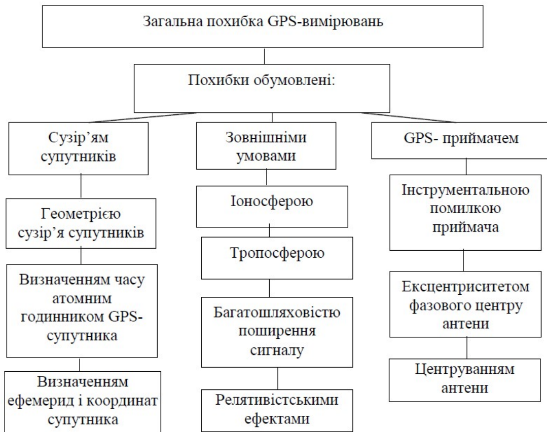
Рис. 10.5. Структура похибок, що виникають під час GPS-спостережень [11]
