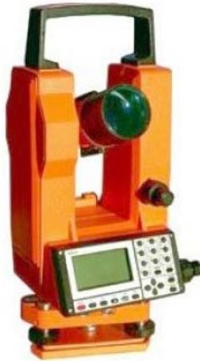
Рис. 4.7. Точний електронний теодоліт 2Т5Е: 1 – підставки; 2 – дисплейна панель керування; 3 – навідний та закріпний гвинти аліади; 4 – навідний та закріпний гвинти зорової труби; 5 – зорова труба
