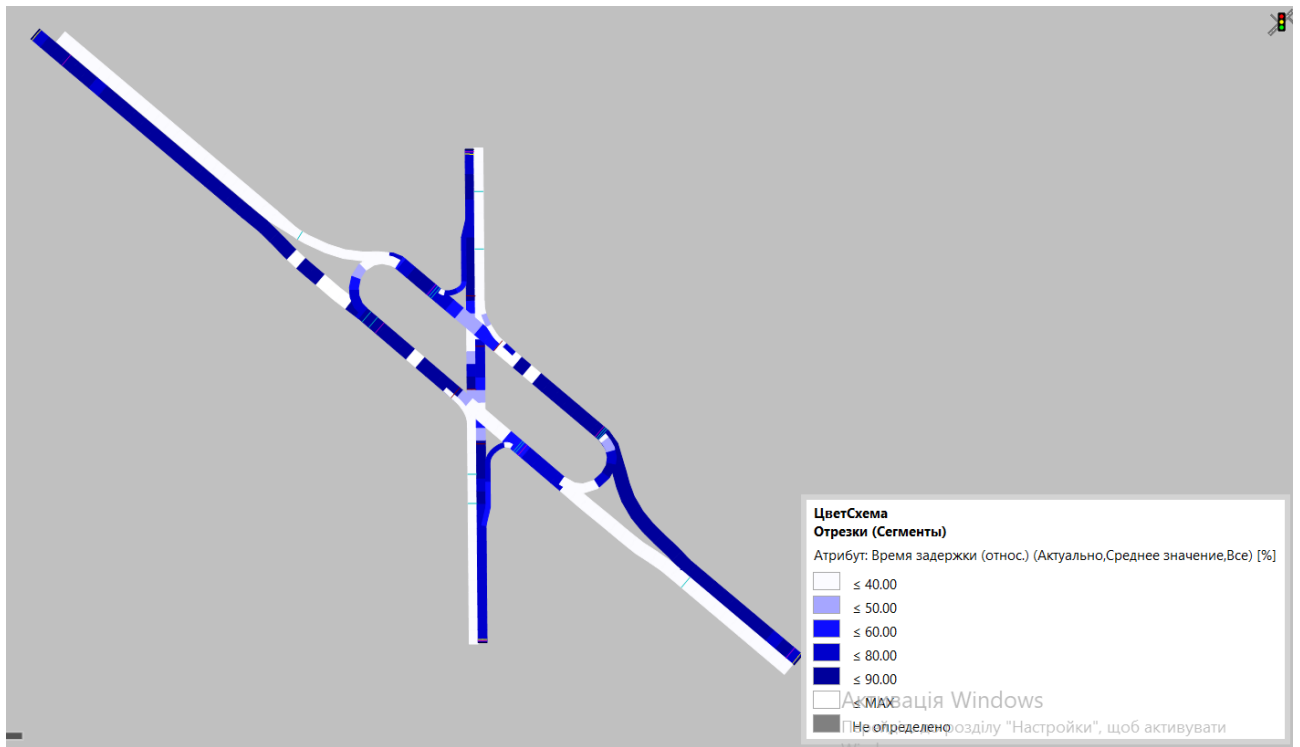
Рис. А.5 Теплова карта «Час затримки», перетин вул. Стеценка – вул. І. Виговського, проектний стан.
