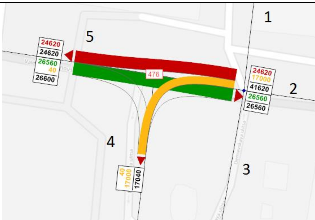
Рис.1.14 – Картограма добових інтенсивностей за напрямками на перетині вул.Деміївська – пр.Валерія Лобановського Для зручності роботи із даними пропонуую занести їх у таблицю 4.
