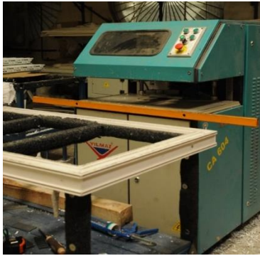
Рис. 2.15. Фрезерний верстат для обробки кромки
