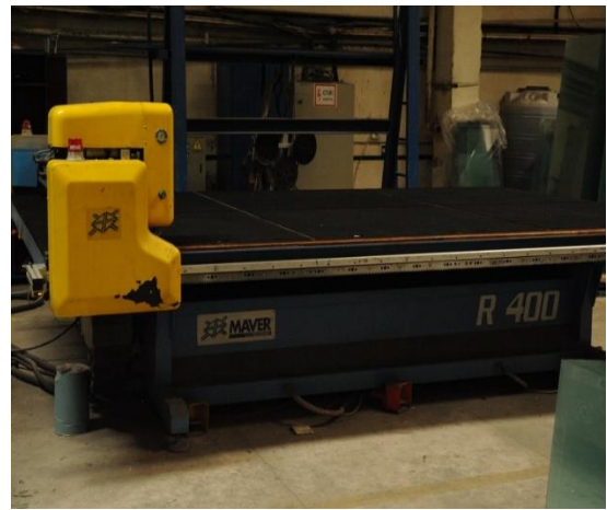
Рис. 2.18. Установка для різання скла
