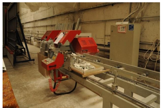
Рис. 2.14. Двухголовочна пилка для різки профілю
