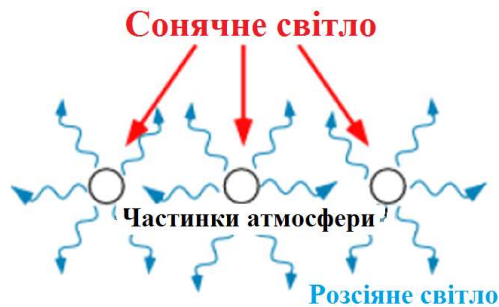
Рис. 6. Розсіювання ЕМВ частинками в атмосфері [19]
