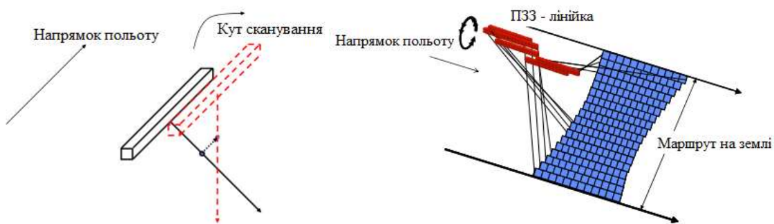
Рис. 20. Принцип роботи та покриття сцени панорамного лінійного сканеру [19]
