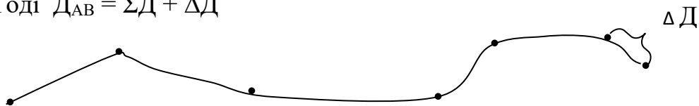
Рис. 6. Вимірювання довжини хвилястої лінії
