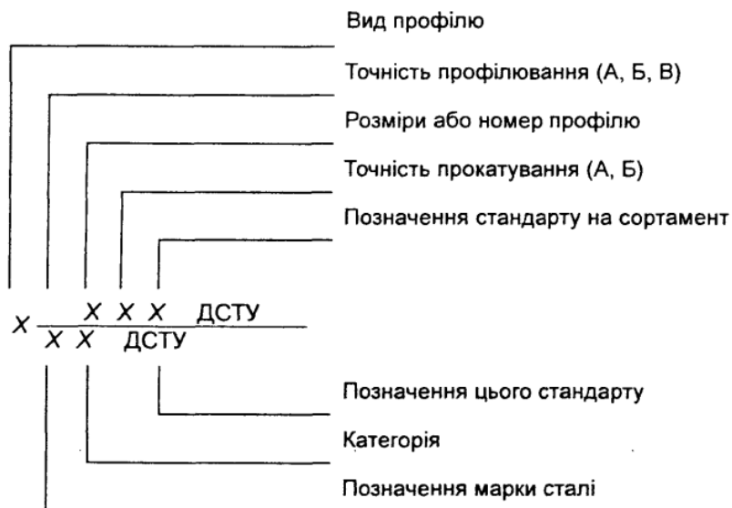
Рис.2.5 Схема та приклади умовних позначень гнутих профілів
