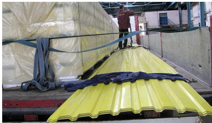
Рис. 4.1 Фотографічне зображення процесу пакування профнастилу
