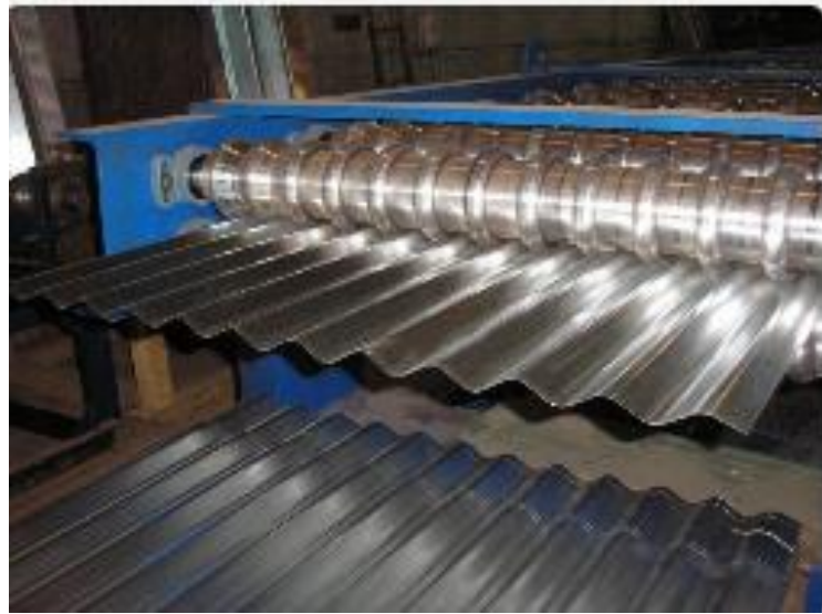
Рис. 2.3 Прокатування профнастилу через ролики профілезгинних верстатів
