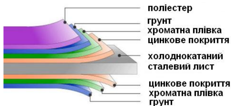
Рис. 3.4 Переріз листа профнастилу із захисним покриттям
