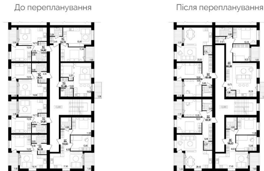
Рис. 19 План секції з можливим переплануванням концептуального проекту соціального житла, селище Олешин, Хмельницька область [45]
