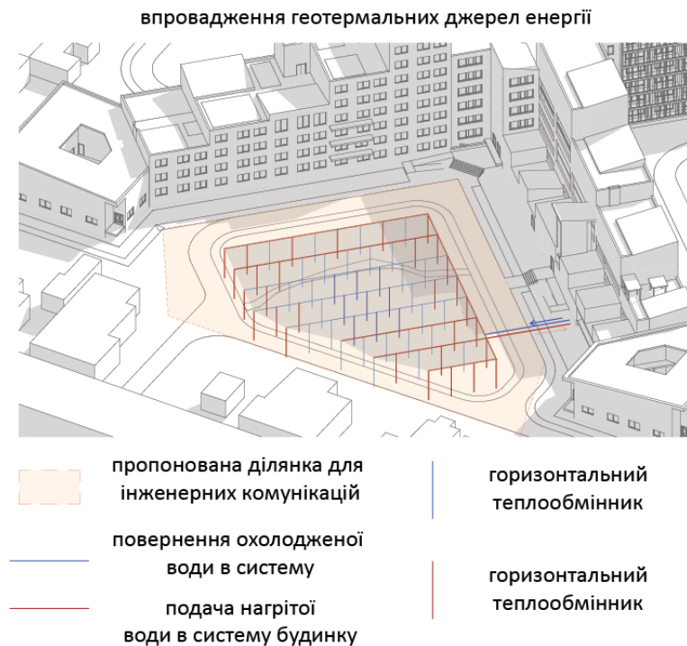
Рис. 57 Ділянка для впровадження геотермальних систем опалення
