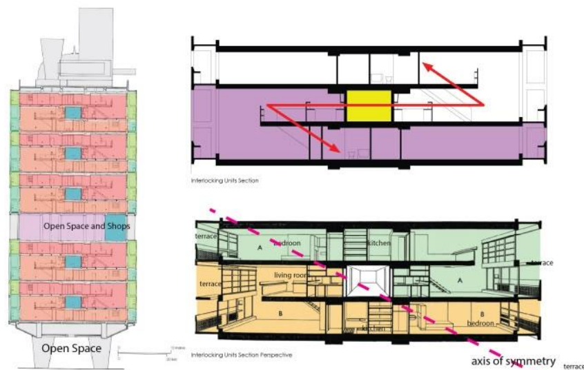
Рис. 26 Функціональна схема Марсельська житлова одиниця (Unite d'Habitation), Ле Корбюзьє, 1952 [37].
