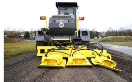
Рис. 1.12 Навісна віброплита Stehr SBV 80 H3 SK | 3 x 80 kN
