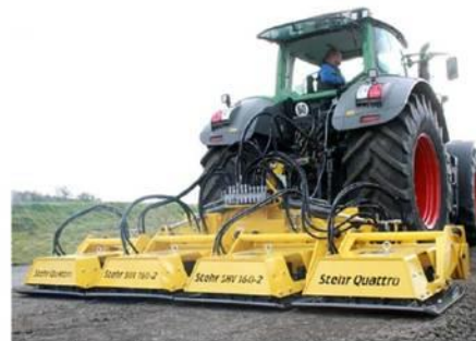
Рис. 1.11 Навісна віброплита Stehr SBV 160-2 Quattro | 4 x 160 kN
