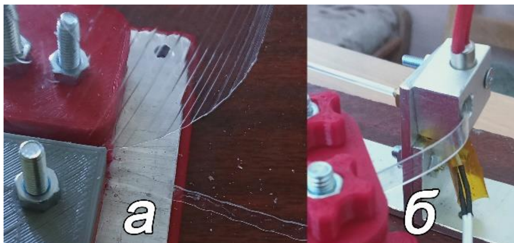
Рисунок 1 – Перетворення PET полоси у пруток пластику
