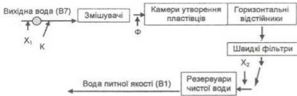
Рис. 16. Блочна схема очищення води на горизонтальних відстійниках Місця вводу реагентів (розчинів): X_1, X_2 - хлору, K - коагулянту, \Phi - флокулянту.
