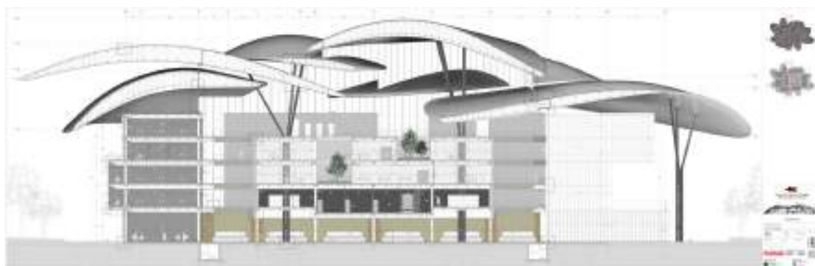
Рис. 2.8. Розріз Б-Б' будівлі. [25]
