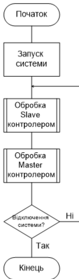
Рис. 4.2 Алгоритм керування системою димовидалення
