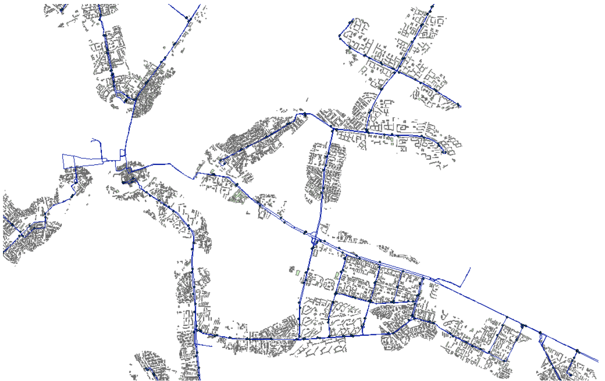
Рис.3.5. Геоінформаційна модель розміщення житлових будівель на території міста Харкова, які знаходяться в зоні пішоїдної доступності R \leq 500 м до зупинок тролейбусу.
