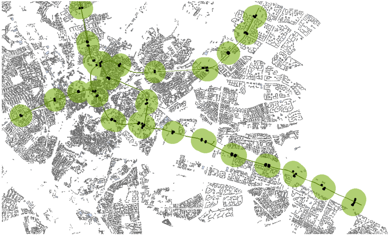
Рис.3.6. Геоінформаційна модель буферних зон пішоїдної доступності при умові R \leq 500 м від зупинок метро
