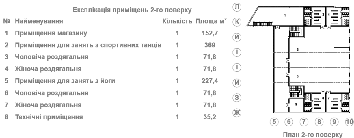
Рис. 3.13 План та експлікація приміщень 2-го поверху на відмітці +1.200
