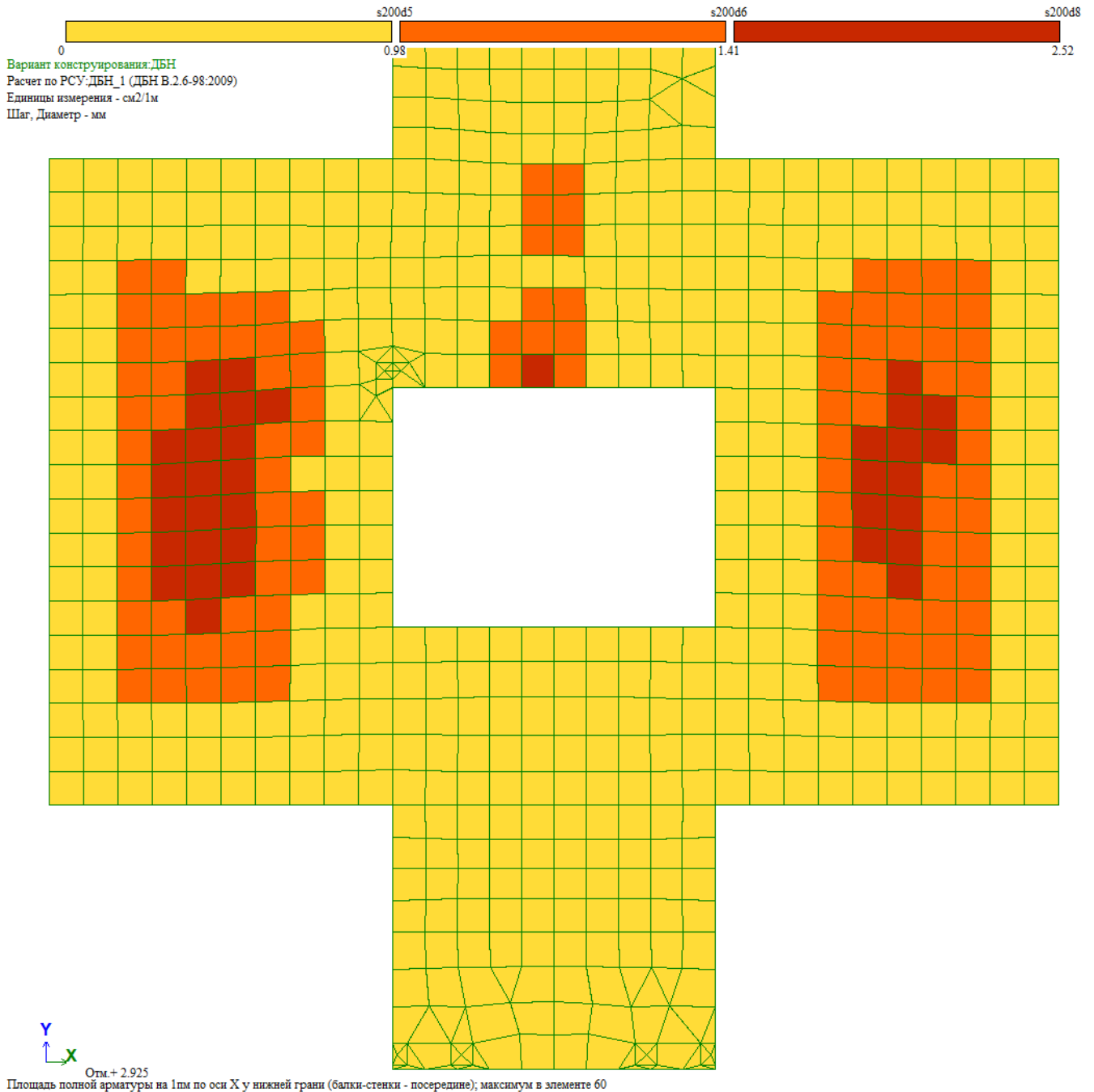
Рис. 3.3.6 Підбір нижньої арматури по осі X (макс. діам. 8мм)
