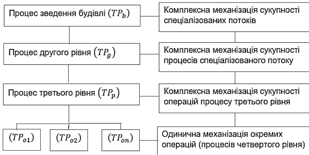
Рис. 4.1. Структура системи «технологічний процес – механізація»
