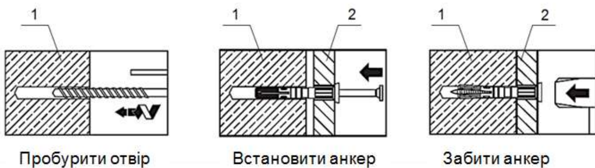
Рис. 12.16. Схема кріплення виробів за допомогою дюбеля-цвяха: 1 – конструкція, 2 – виріб
