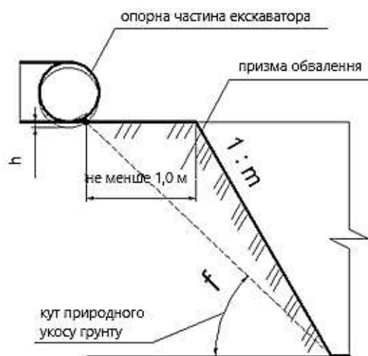
Рис. 8.15. Схема безпечного встановлення екскаватора
