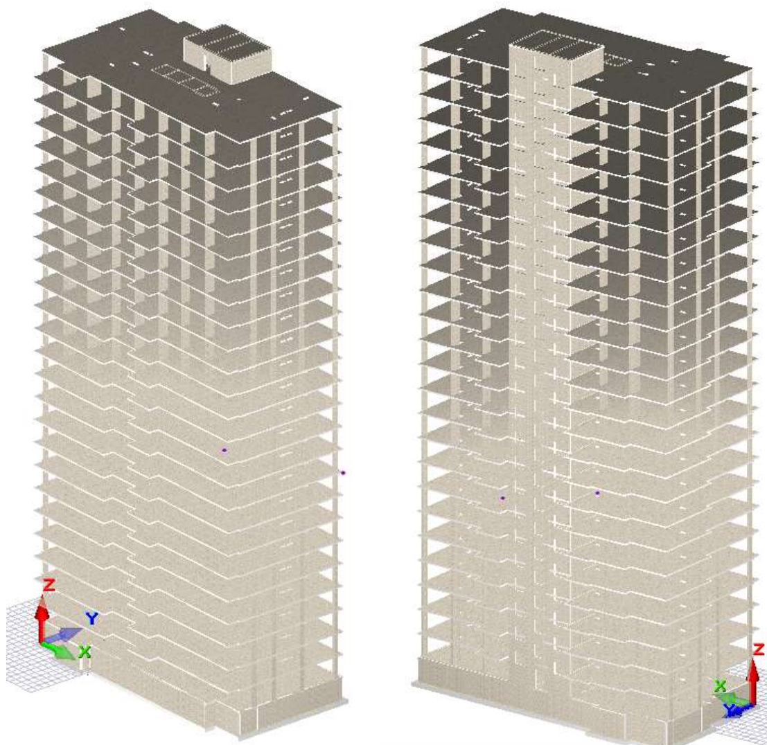
Рис. 2.2. 3D вигляд моделі будівлі в ізометричній проекції.
