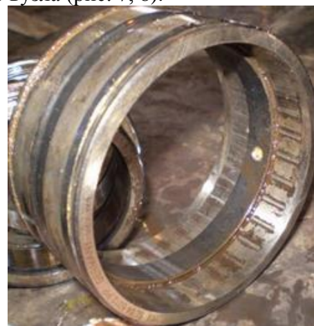
Рисунок 8. Характер зношування роликів дворядних кінцевих підшипників.
