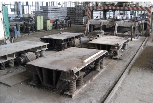
Рисунок 5. Вібротумби уставки для формування панелей перекриття.
