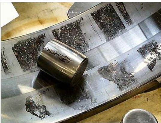
Рисунок 7. Характер зношування роликів сферичних підшипників віброплощадок.
