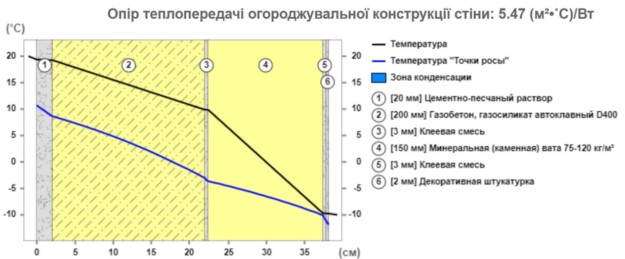
Рисунок 1.1 – Опір теплопередачі конструкції зовнішньої стіни
