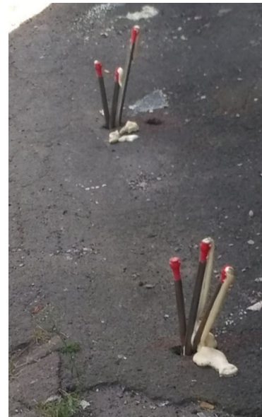
Рис. 3.2 – Принципова схема встановлення трубок в пробурений отвір
