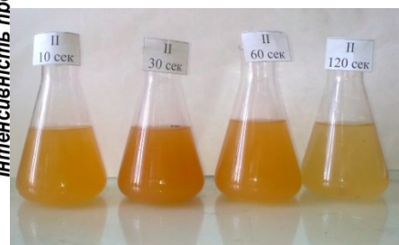
Рис. 5. Проби промивної води після фільтра в різні проміжки часу: а – I ступінь промивки; б – II ступінь промивки
