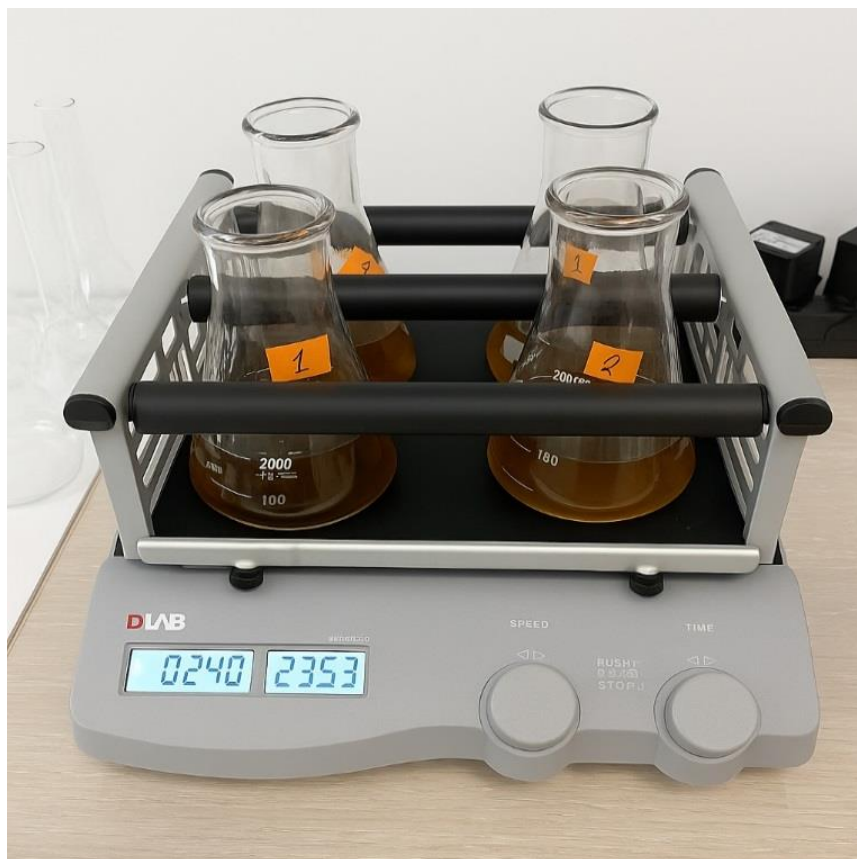
Рисунок 2.2 - Лабораторний прилад для дослідження процесу сорбційної очистки стічних вод від іонів заліза
