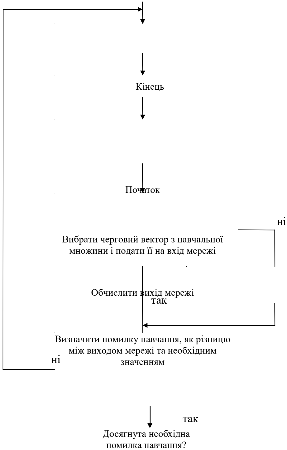
Рисунок 4.6 Спрощена структура алгоритму зворотнього поширення помилки підкорегувати послідовно ваги мережі спочатку між вихідним та прихованих шарів, потім між прихованим і вхідним
