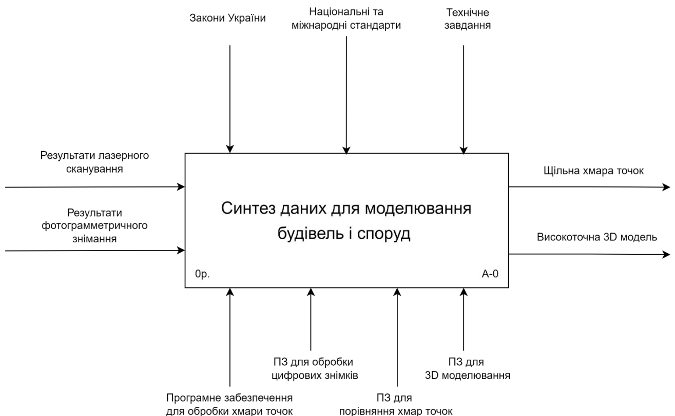
Рис. 2.5 Функціональна модель синтезу даних для моделювання будівель і споруд. Рівень А0
