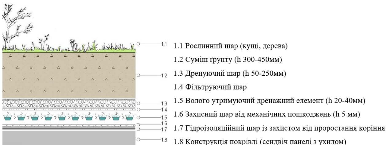
Рис.6.8. Архітектурне рішення благоустрою покрівлі (основний вузол) [37]
