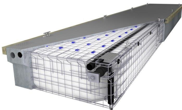
Рис.6.3. Модель бетонного понтона [32]
