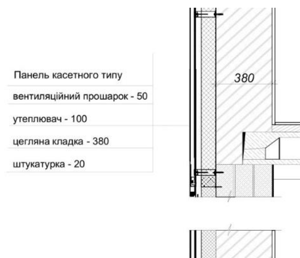
Рис. 6.1 Пиріг зовнішньої стіни
