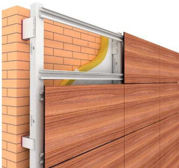
Рис. 6.2 Схема монтажу фасадних панелей HPL [13]
