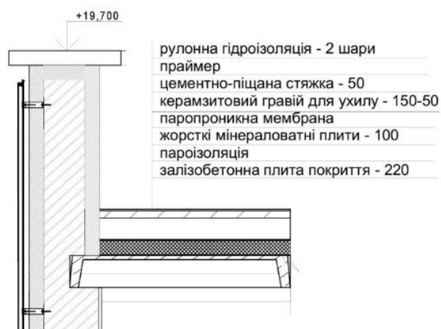
Рис. 6.4 Піріг покрівлі
