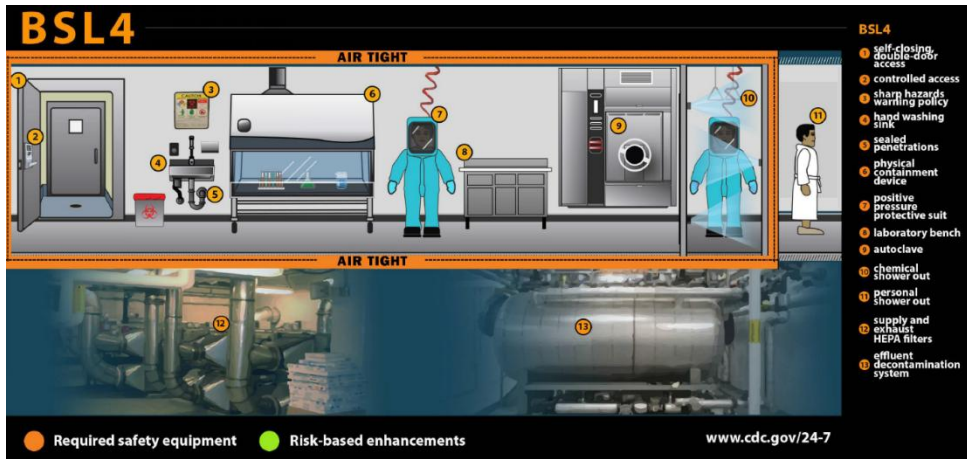
а. Схема принципу функціонування лабораторії BSL-4
