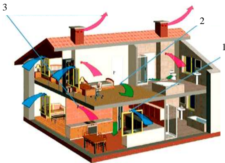
Рис. 19. Схема влаштування природної вентиляції одноквартирного житлового будинку:
