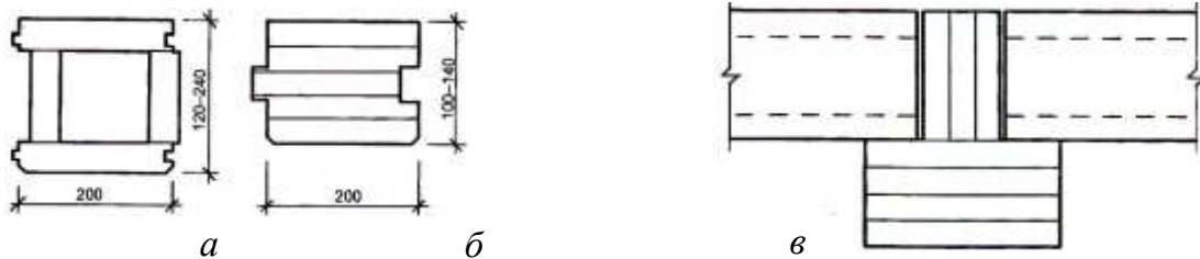
Рис. 122. Балкові дерев'яні клеєні елементи перекриттів: а – коробчастого перерізу; б – суцільного перерізу; в – спирання на головну балку або ригель
