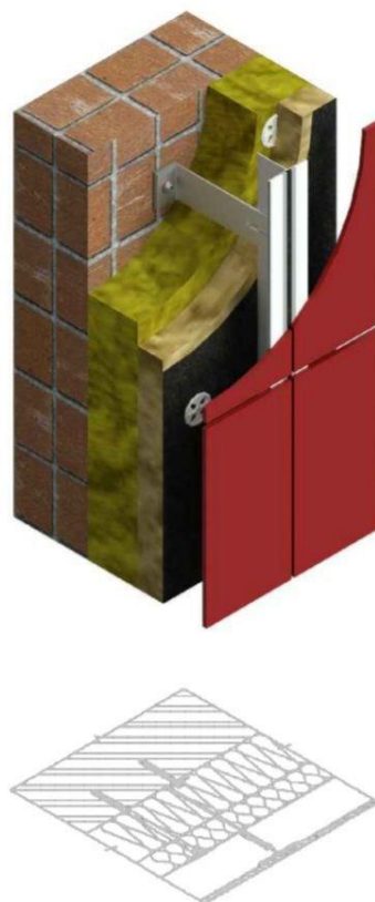
Рис. 6.3 Конструкція HPL-панелей на клейову систему [20]
