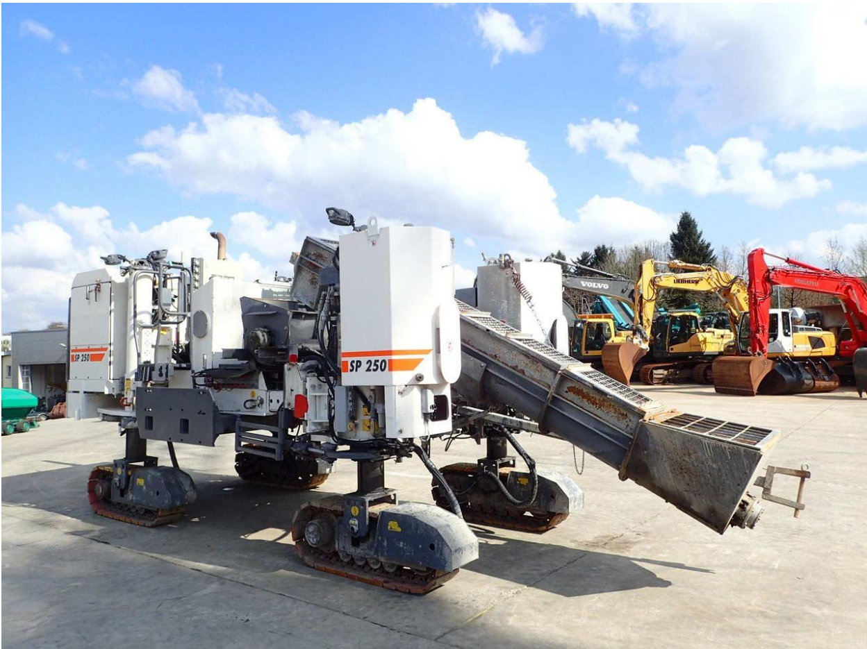
Рис. 1.5 Бетоноукладач Wirtgen SP-250
